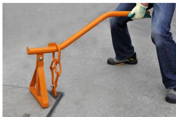
Deckelheber mit Dreieckstütze und Hebezange
