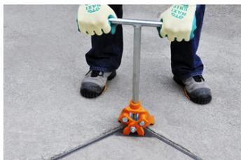
Deckelhebezange mit Spindel
