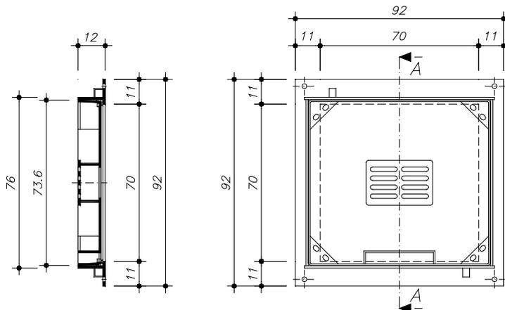
Schachtabdeckung im Flachstahlrahmen 70 x 70 cm i.L. Beton:  $\geq$  C 35/45
