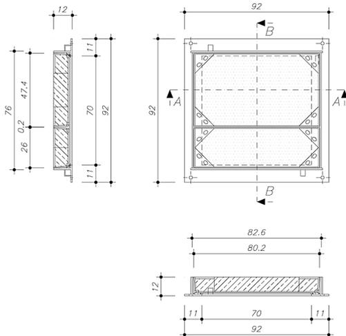
Schachtabdeckung im Flachstahlrahmen 70 x 70 cm i.L. mit 2-teiligem Deckel, Beton:  $\geq$  C 35/45
