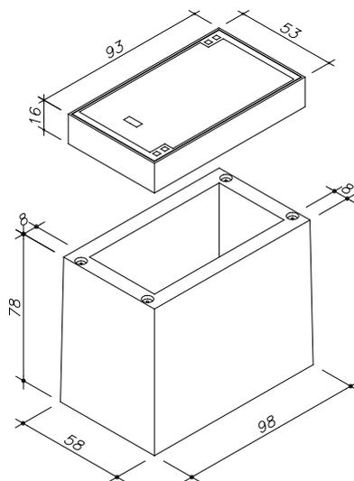
Schachtabdeckung mit Entlüftung
