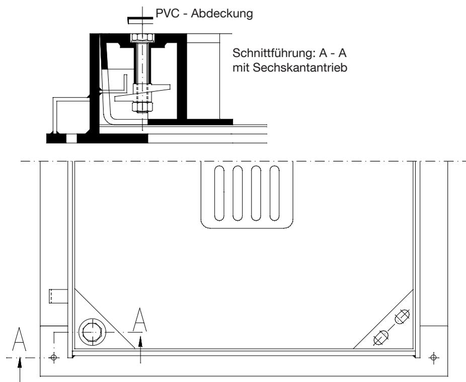
(Bsp.: AB 70 x 70 FL mit Lüftungsrost)
