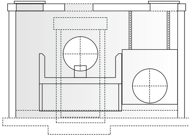
**Materialgüte: Stahlbeton C 35/45, auf Wunsch HS-Zement.**
